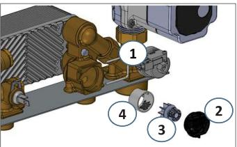
Figure 87 - Removing the DHW Filter
